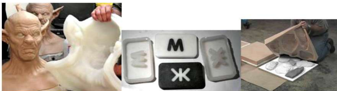
Рис. 3 Двухкомпонентный жидкий полиуретан для производства форм.
