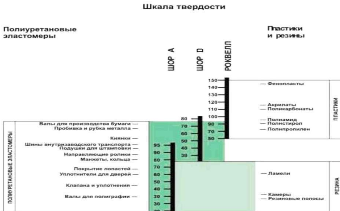
Рис. 1. Шкала твердости поверхности изделий из полиуретана.
